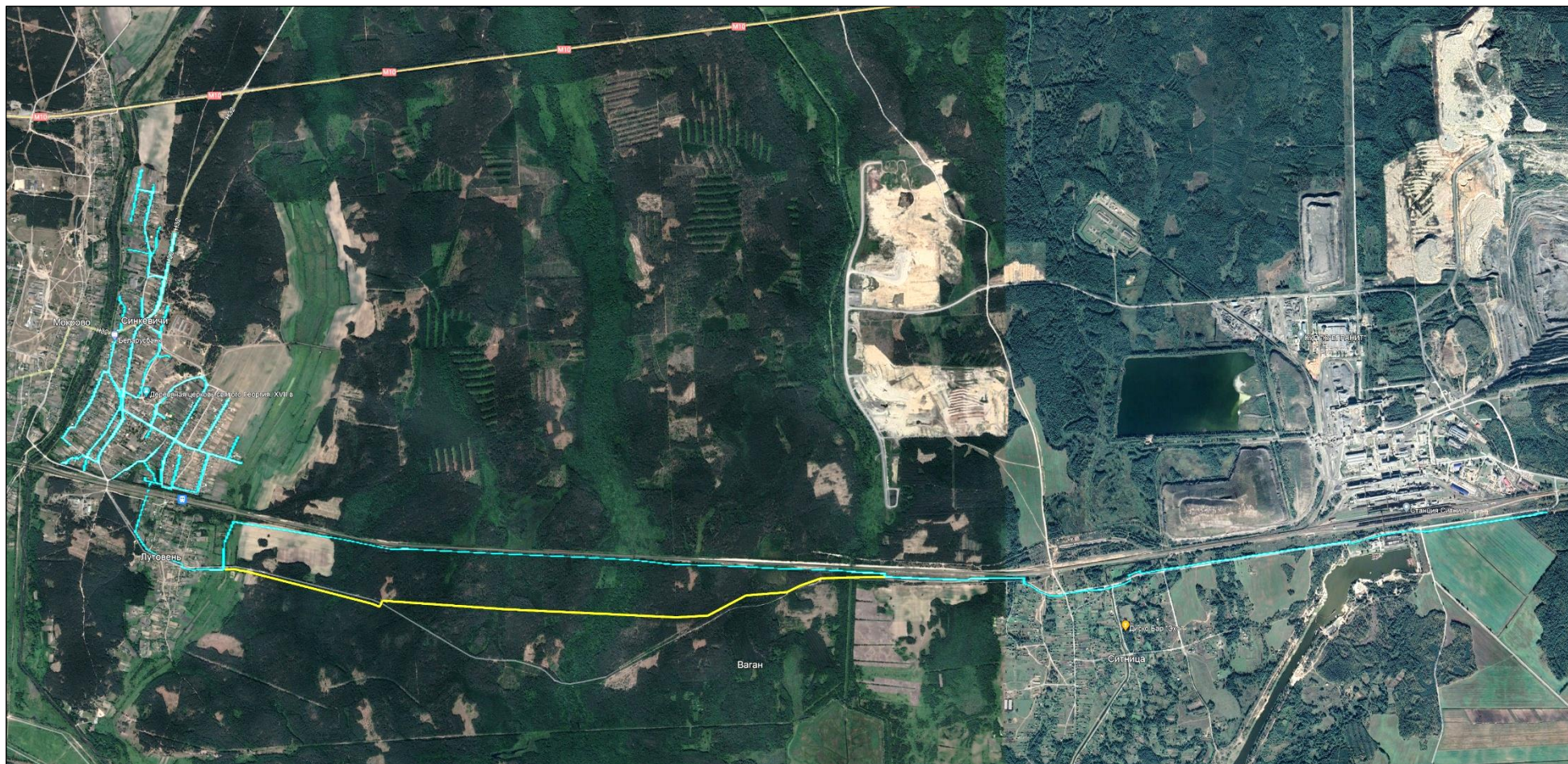
Рисунок 2.1 – Обзорная схема расположения трассы проектируемого газопровода (голубая линия – основной вариант, желтая линия – альтернативный вариант)
